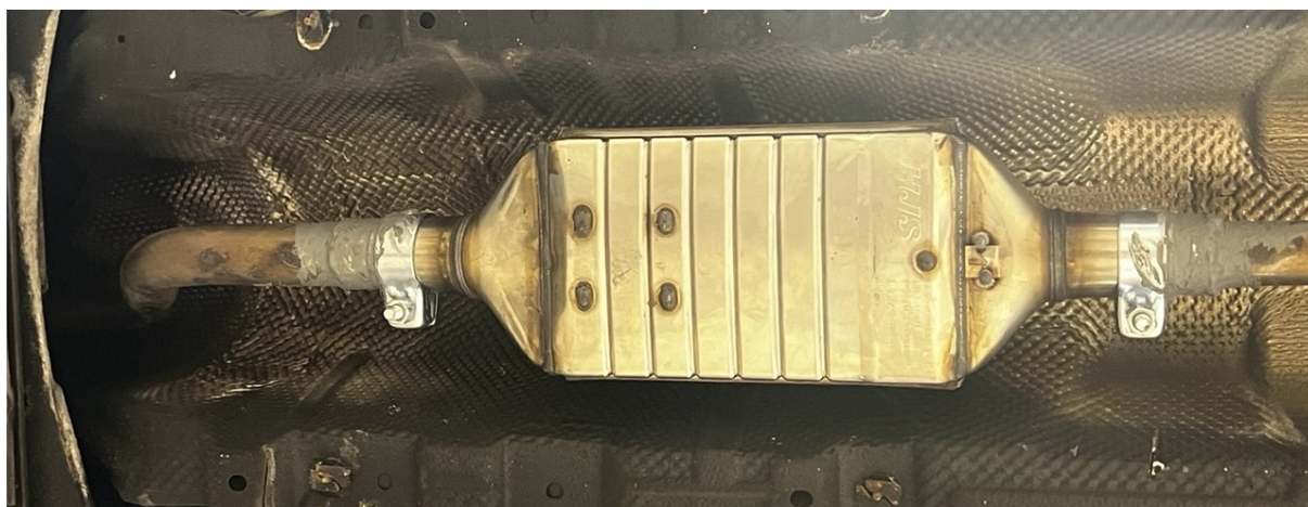
DPF monteret med clamps. OBS: brug ikke udstødningsspasta som vist på billede.
